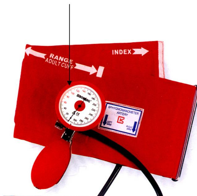
Slika 1: Fotografija tlakomjera za krvni tlak tip BK 2066 s prikazom mjesta za smještaj ovjerne naljepnice
